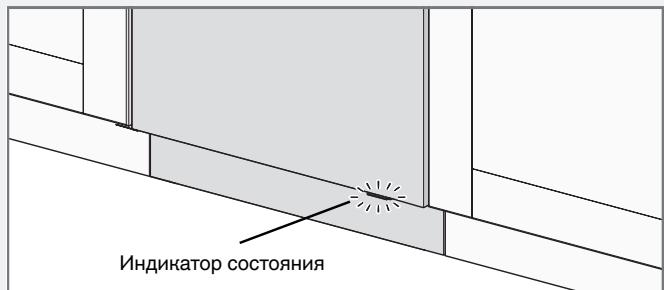
У светового индикатора состояния в нижней части машины 3 цветовых режима.
