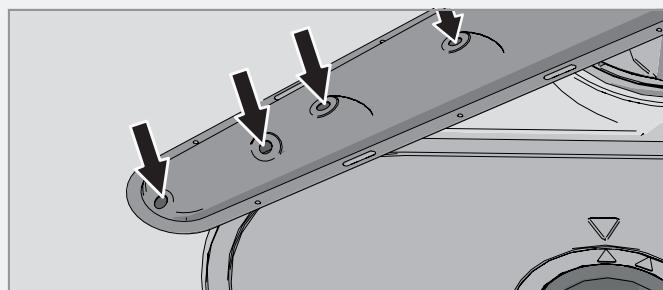
Чтобы облегчить очистку, можно снять разбрзгиватели. Не забудьте надежно установить их обратно после очистки.
